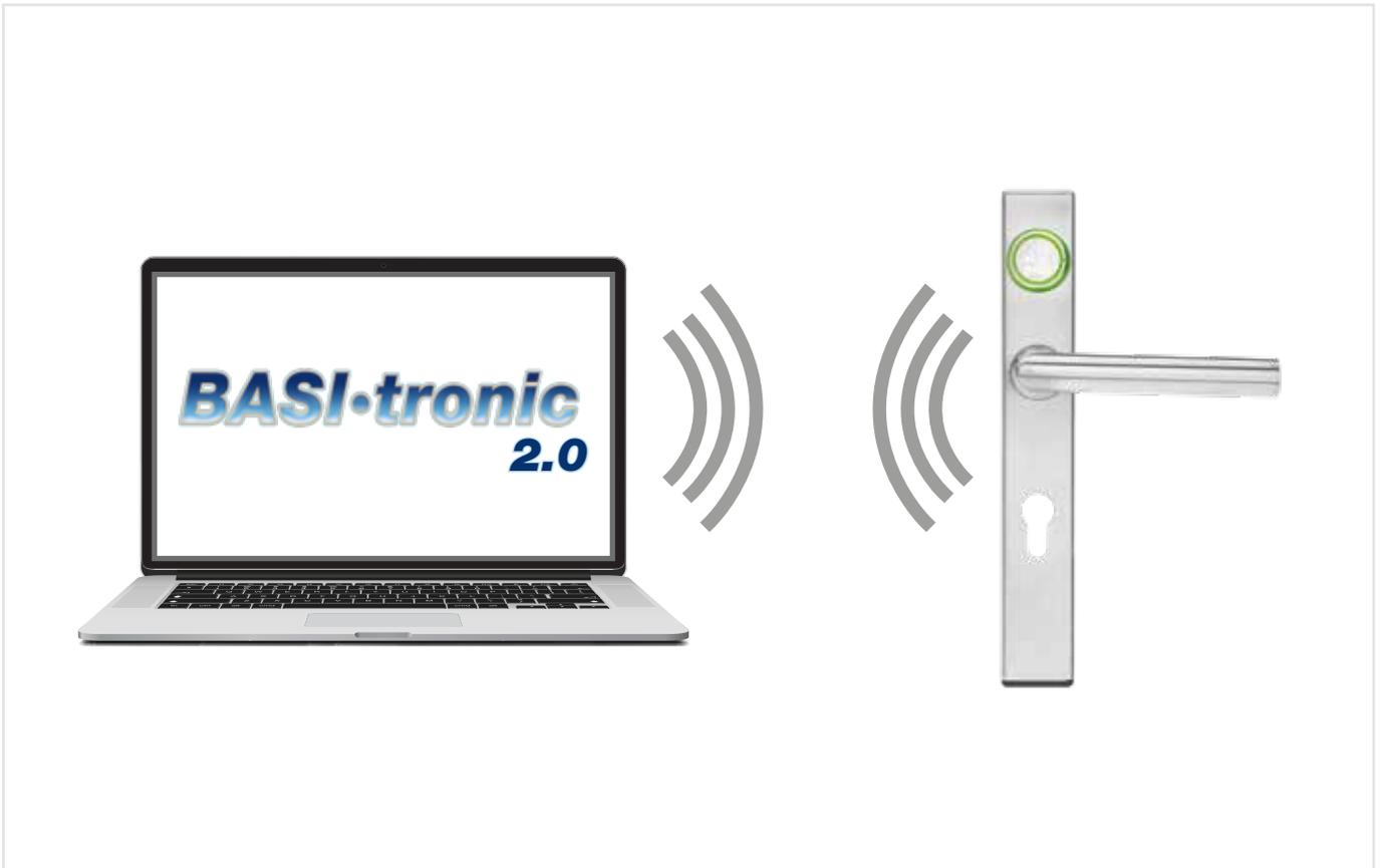
Mittels Funkstick kommuniziert der Elektronikzylinder mit der Verwaltungs- & Programmierungssoftware.
