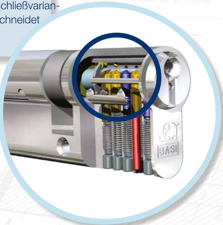
In das Schlüsselprofil ist ein Steuerelement (Rolle) eingesetzt, durch welches zwei in den Kern verbaute Sperrelemente betätigt werden. Diese Sperrelemente verhindern, bei Nichtvorhandensein des Steuerelements im Schlüssel, die Drehung der Kerne. Die konstruktive Auslegung des Steuerelements im Schlüssel macht eine nicht legitimierte Nachfertigung der Schlüssel ausgeschlossen. Die Konstruktion ist patentrechtlich geschützt (EP 1 662077 A1).
