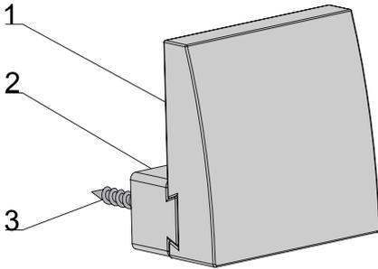
Abbildung 2: Montage des Befestigungsblocks
